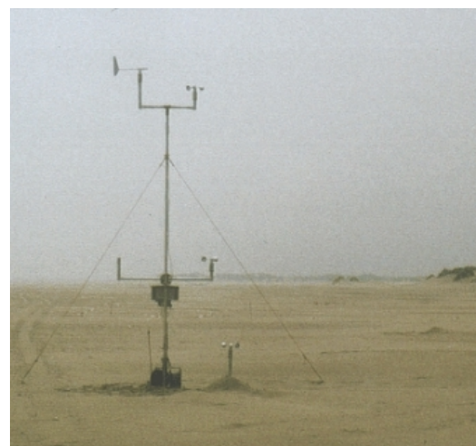
Abbildung 2: Messung des Windprofils mit Schalenstern-Anemometern
