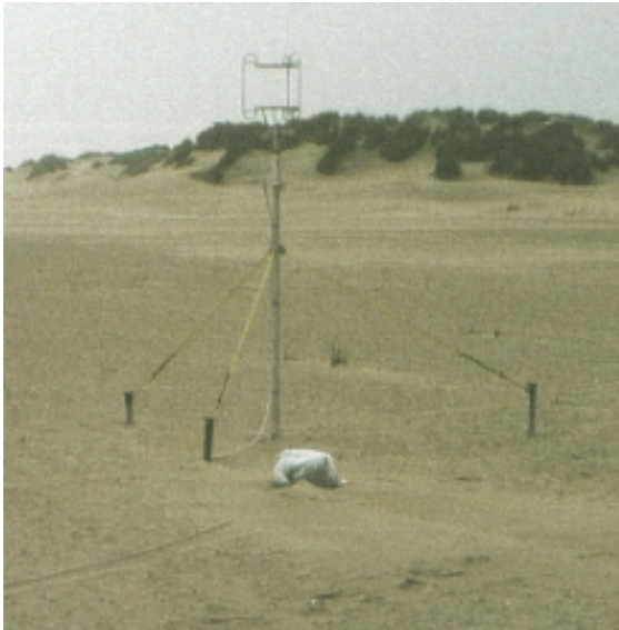
Abbildung 3: Zeitlich hochauflösende Meßsysteme – links: Ultraschall-Anemometer-Thermometer, rechts: Piezoelektrische Sanddriftsensoren
