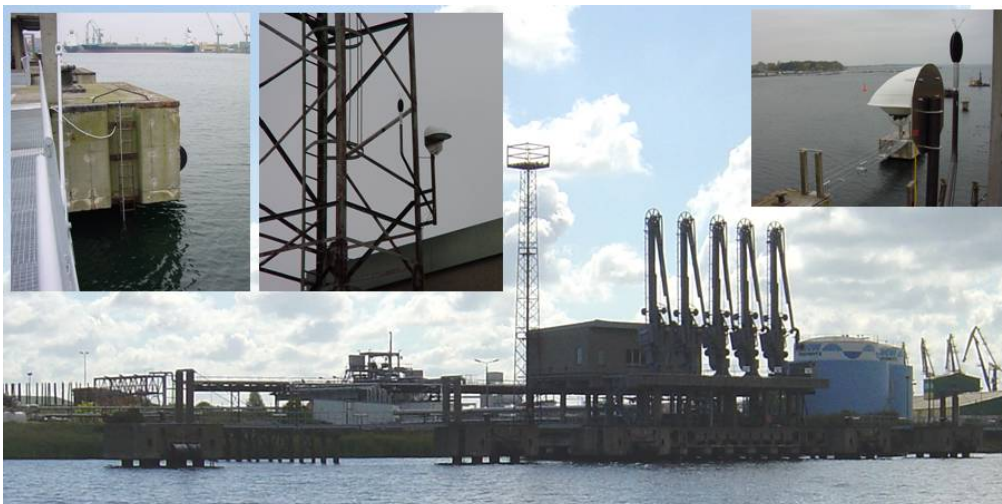
Abb. 5: Photographie der Installation des Außenmikrophons und der Digitalkamera an der Flüssiggutumschlagsanlage im Hafen Wismar (Photos: BfG, M1, D. Lippert u. S. Mai)
