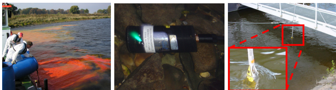
Abb. 2: Durchführung und Instrumentierung der Tracerversuche (links: Tracereinleitung, Mitte: Fluorimeter im Gewässer, rechts: Laser-Fluoreszenz-Spektrometer OPTIMOS)
